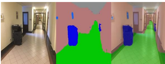
Рис. 2. Результаты работы модуля распознавания препятствий на изображении
