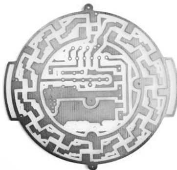
Рис. 7. Плата, изготовленная на станке с ЧПУ
