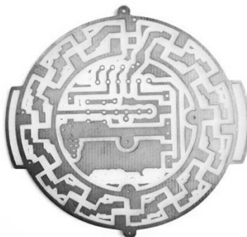
Рис.7. Плата, изготовленная на станке с ЧПУ
