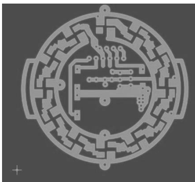
Рис.1. Готовая модель печатной платы в программе Sprint layout
