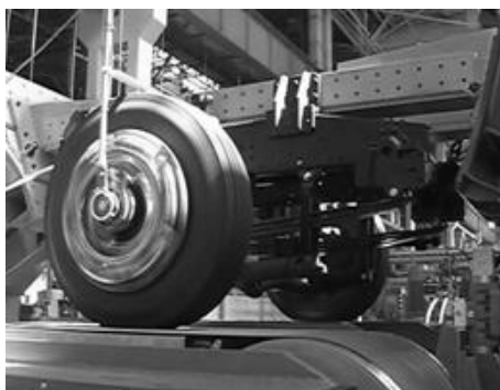
Рис. 1. Испытания передней оси КТС на стенде
