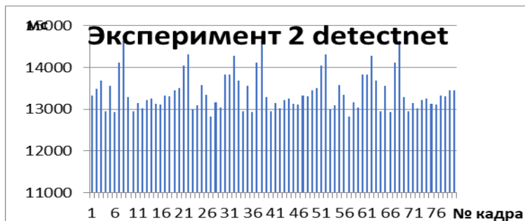
Рис. 3. Диаграмма времени обработки кадров видеопотока с помощью сети DetectNet
