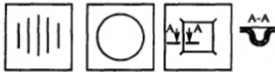
Рис. 4.4.3. Конфигурация выдавок тонкостенных конструкций деталей
